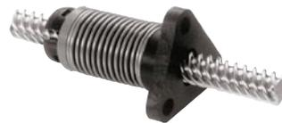
Серия ZBX лучше всего подходит для применения, когда необходимы точные линейные движения и повторяемость при небольших затратах. Гайка ZBX имеет радиальное напряжение смещения относительно резьбового стержня, что гарантирует хорошую повторяемость. Серия ZBX особенно подходит для вертикального использования, где от гайки так же требуется уменьшение шума или механической вибрации.
