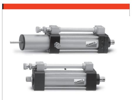
Стандартные гидродемпферы Серии 43 поставляются с двумя типами управления: регулируемым движением вперед с последующим быстрым отводом или быстрым движением вперед и регулируемым движением назад. Гидродемпфер поставляется вместе с заправленным расширительным бачком, который служит для устранения гидроударов. Управление скоростью осуществляется с помощью встроенного регулятора расхода, обеспечивающего возможность регулировки в широких пределах, и рассчитанного на непрерывный режим работы.
