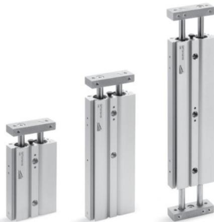
Цилиндры Серии QX идеально подходят для решения задач линейного перемещения по направляющим. Конструкция с двумя штоками помимо обеспечения направленного перемещения позволяет удвоить усилие при сохранении компактных размеров. Цилиндры могут поставляться с направляющими на основе подшипников скольжения из спеченной бронзы или на основе шариковых линейных подшипников качения.
