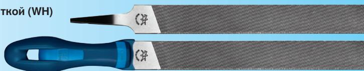
Плоский напильник с рукояткой и насечкой с трёх сторон, одна сторона без насечки; DIN 7261, форма A; три типа насечек: насечка 1 (грубая обработка), насечка 2 (универсальная), насечка 3 (тонкая обработка)
