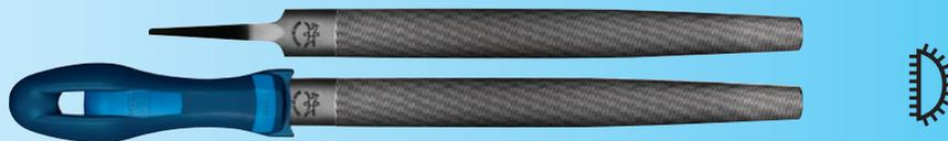
Полукруглый, остроносый напильник обладает хорошим свойством опиливания, благодаря специальной, спиральной насечке. Полукруглый, остроносый; аналогичен DIN 7261, форма E, три типа насечек: насечка 1 (грубая обработка), насечка 2 (универсальная), насечка 3 (тонкая обработка)
