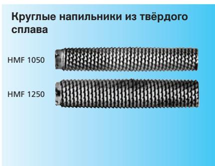
Круглые напильники предназначены для обработки вогнутых поверхностей. Своеобразная геометрия насечки гарантирует высокую производительность. Круглые напильники имеют спиральную насечку. Захват держателя HMFH 51 R сконструирован таким образом, что напильник с шагом в 60° поворачивается вокруг своей оси. Благодаря этому возможно использование на 360°.
