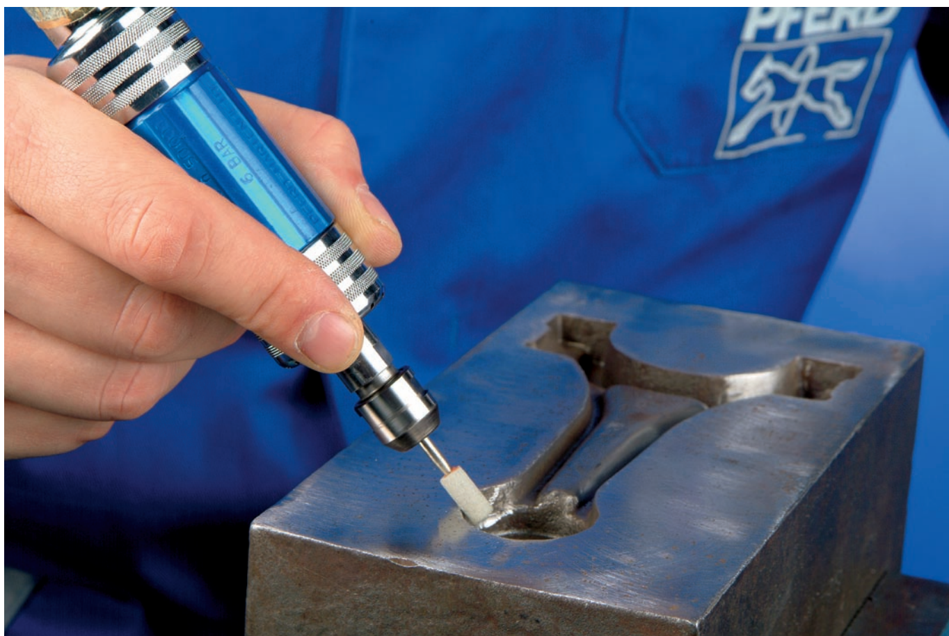
Устранение грат на штамповой форме из кованого материала.
