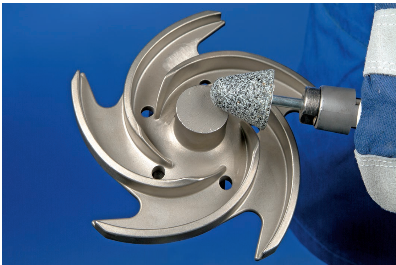
Устранение литников на деталях из легированной стали.
