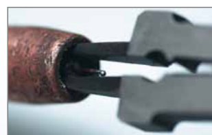
предотвращающая разбрызгивание форма насадки
