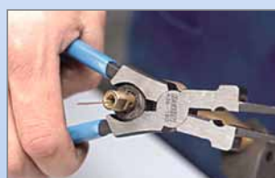
устройство для снятия и установки втулки
