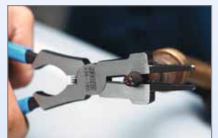
удаление и установка жиклера
