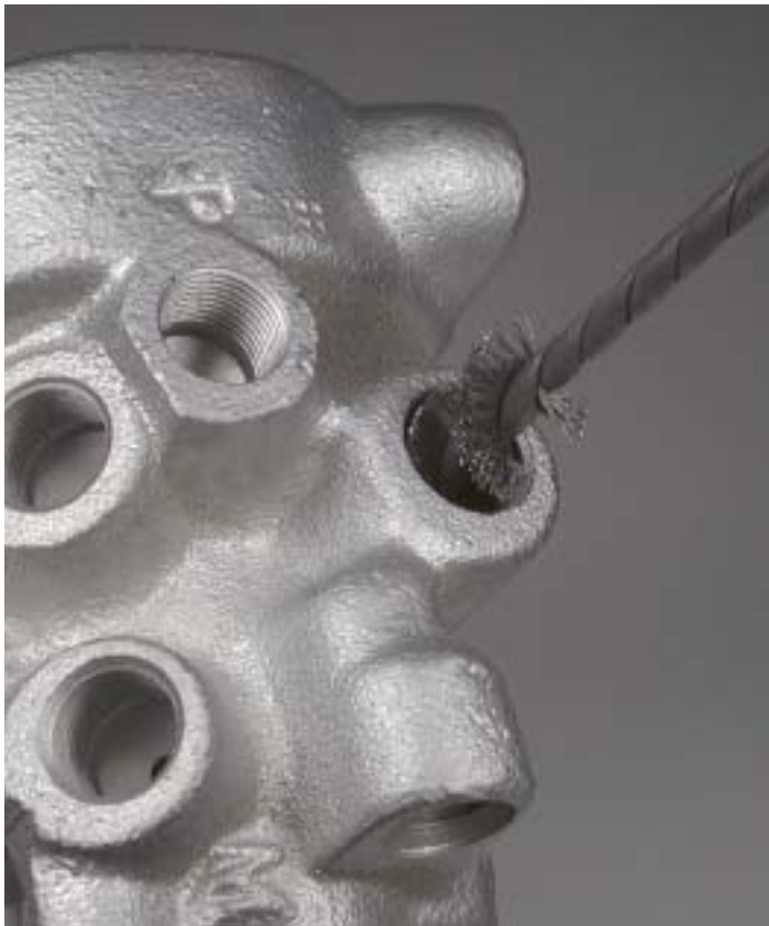
Steuergehäuse, Entgraten von Gewindebohrungen Valve gear casing, Deburring tepped holes
