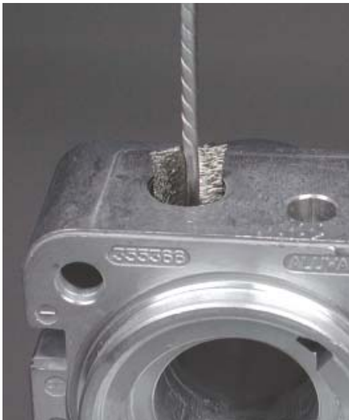
Steuerzylinder, Entgraten von Bohrungen Steering cylinder, Deburring drill holes
