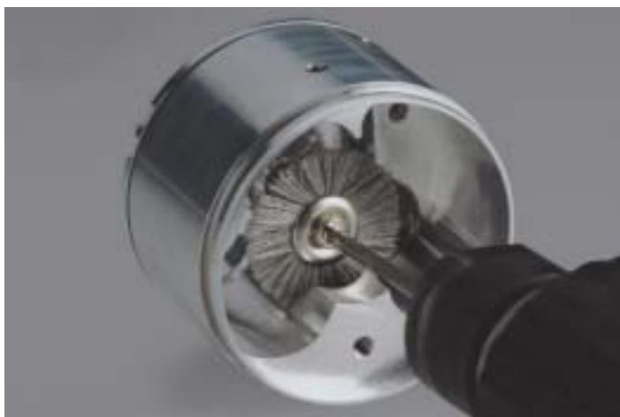
Aluminiumgehäuse, Entgraten Aluminium housing, Deburring
