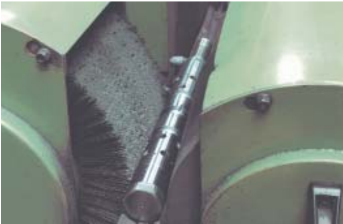
Entgraten von Hydrauliksteuerkolben. Deburring of hydraulic control pistons.
