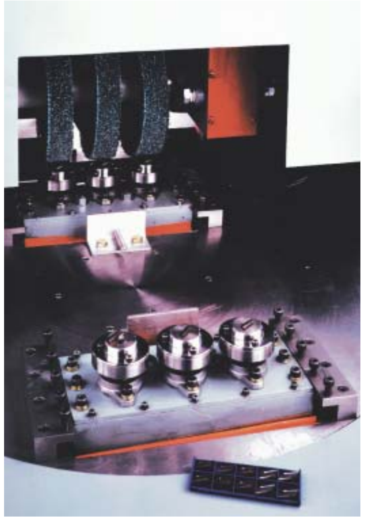
Entgraten von Hartmetall- oder Keramik-Wendepplatten
